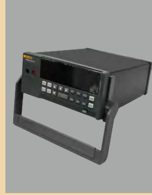
温度数据记录仪 用于验证产品在通电情况下，记录产品表面的温度变化状况
