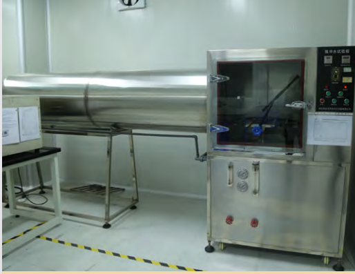
强冲水试验箱 --- IPX5~IPX6 模拟验证高湿环境条件下产品的密封性能
