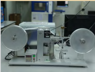
RCA纸带耐磨耗测试机 针对产品表面镀层进行磨耗检测，以验证产品表面镀层耐磨耗之性能
