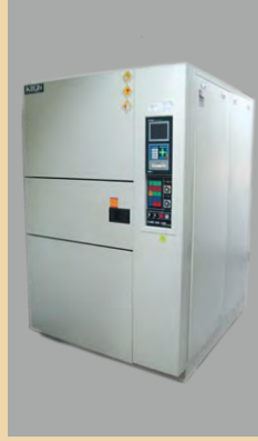
冷热冲击试验机 用于验证产品耐受极端 高低温冲击的能力
