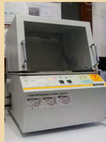
X-射线荧光膜厚仪 主要是用于测试零件的 电镀膜厚
