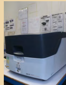
X射线荧光光谱仪 可对样品中元素种类和 含量进行分析鉴定
