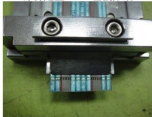
線材定位，YAG雷射割鋁箔
