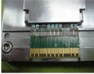
PCB 定位焊接
