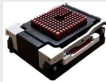
高功率·帶溫控的老化測試治具
